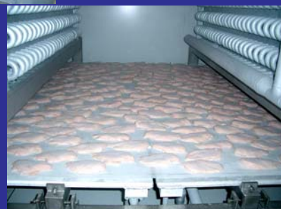
Il permet aussi pour des produits nus délicats de ne pas être marqués et de rester plats, exemple ci-contre : produits enrobés ou ci-dessous crêpes fourrées surgelées.
