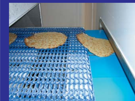
Ce modèle est aussi utilisé pour les produits demandant un temps de passage très court et un convoyage ultra rapide comme les crêpes (30 secondes)
