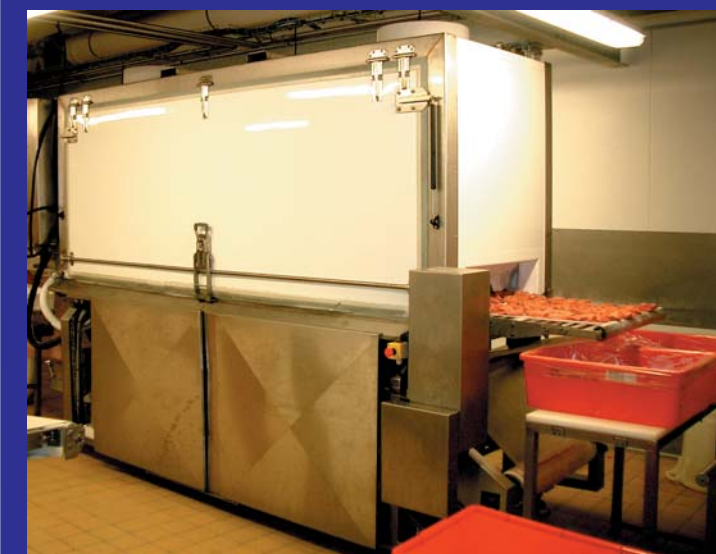
CIMS met à la disposition de ses clients un petit tunnel pilote et une centrale de mesures pour réaliser des essais pour élaborer des nouveaux produits ou valider simplement la bonne adéquation de sa technologie aux applications.
